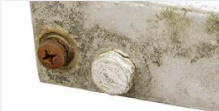
图2：螺纹型防水透气产品在样本设备上的位置
